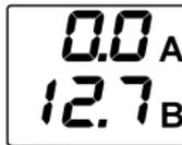
Диапазон измерения вольтметра: **8,5-23 В**, точность  $\pm 0,1 В$
